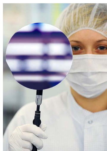
图片来源：欧司朗 今天，基于氮化镓铟 (InGaN) 技术的欧司朗高性能 LED 在直径为 6 英寸的晶圆上制造。
